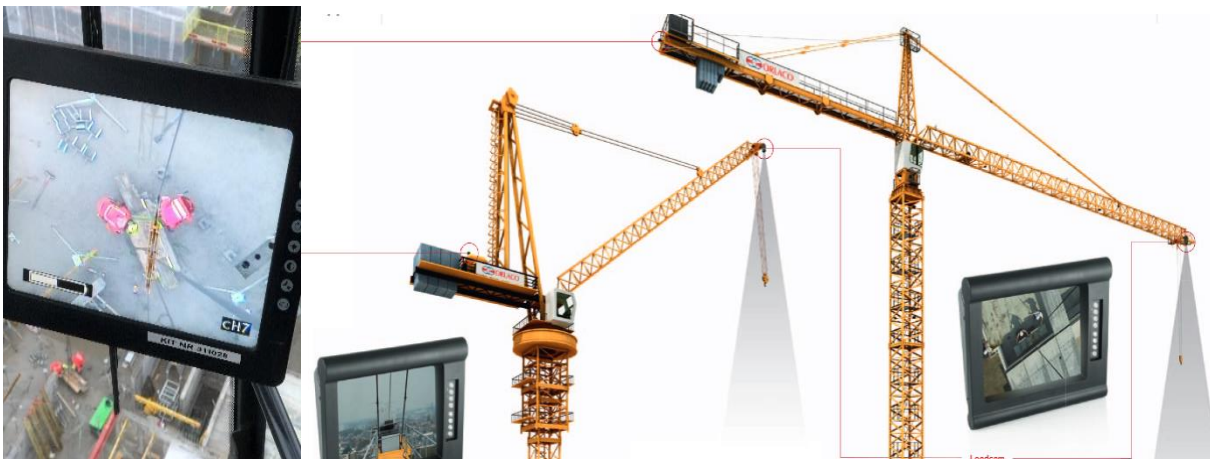
Figur 3 Illustrasjon av kamerafunksjon i tårnkran.
