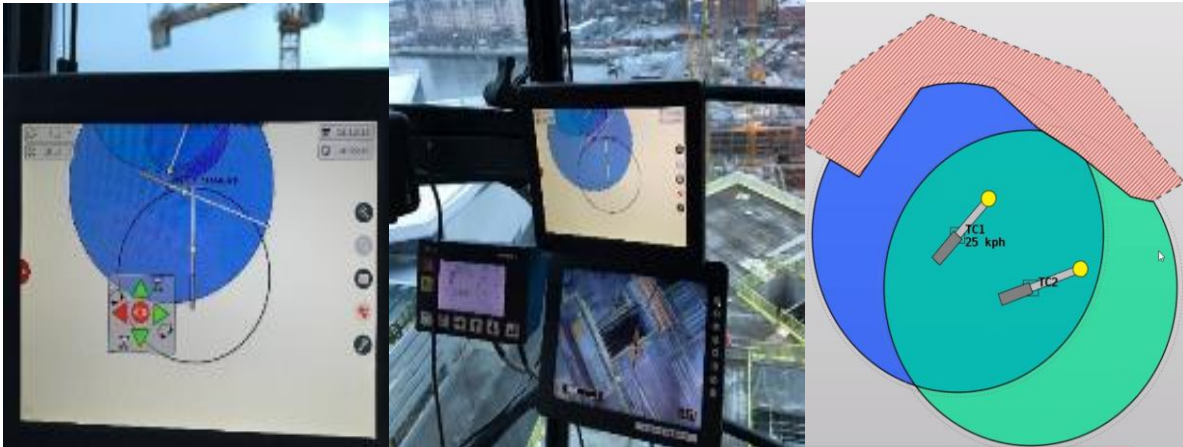
Figur 3 Illustrasjon av kamerafunksjon i tårnkran.
